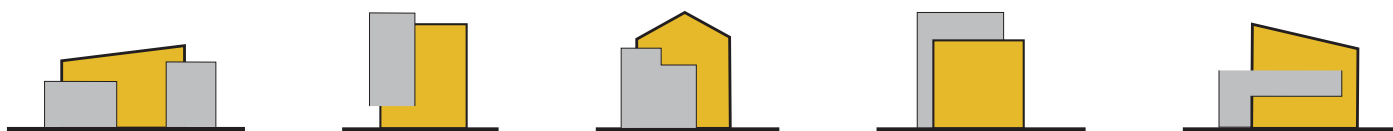
Principskiss för hur en byggnads volym och uttryck kan varieras genom att brytas upp med hjälp av olika former och material.
