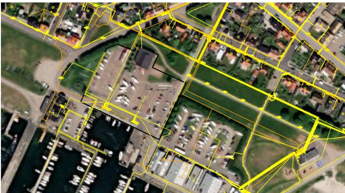
Figur 10. Teleledningar tillhörande Skanova (orange) och gatubelysning, el och opto tillhörande Höganäs Energi (gul). Svart streck visar planområdesgränsen.
