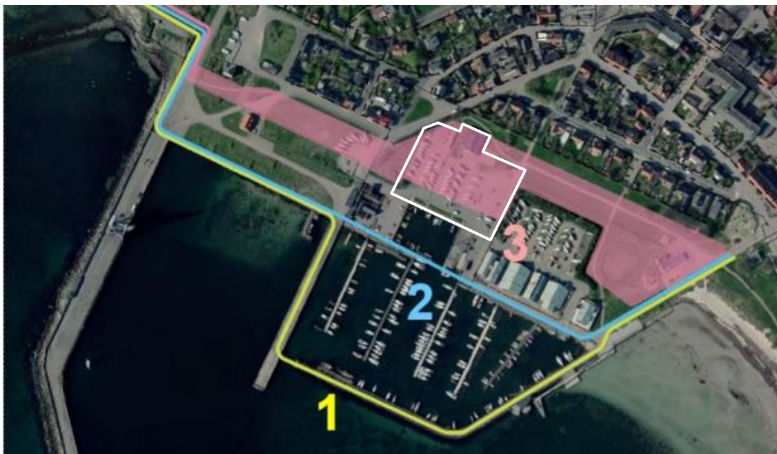
Figur 20. Tre alternativa lägen för högvattenskyddet i Höganäs hamn (DHI, 2022-03-31). Gult (1) illustrerar ett skydd längs med hamnens pirar och med en port vid den yttre öppningen till småbåtshamnen. Blått (2) illustrerar ett skydd längs med kajkanten och en port vid öppningen till den inre delen av småbåtshamnen. Rosa (3) illustrerar höjsättning av grönytor och hotellområde. Planområdet är markerat i vitt.
