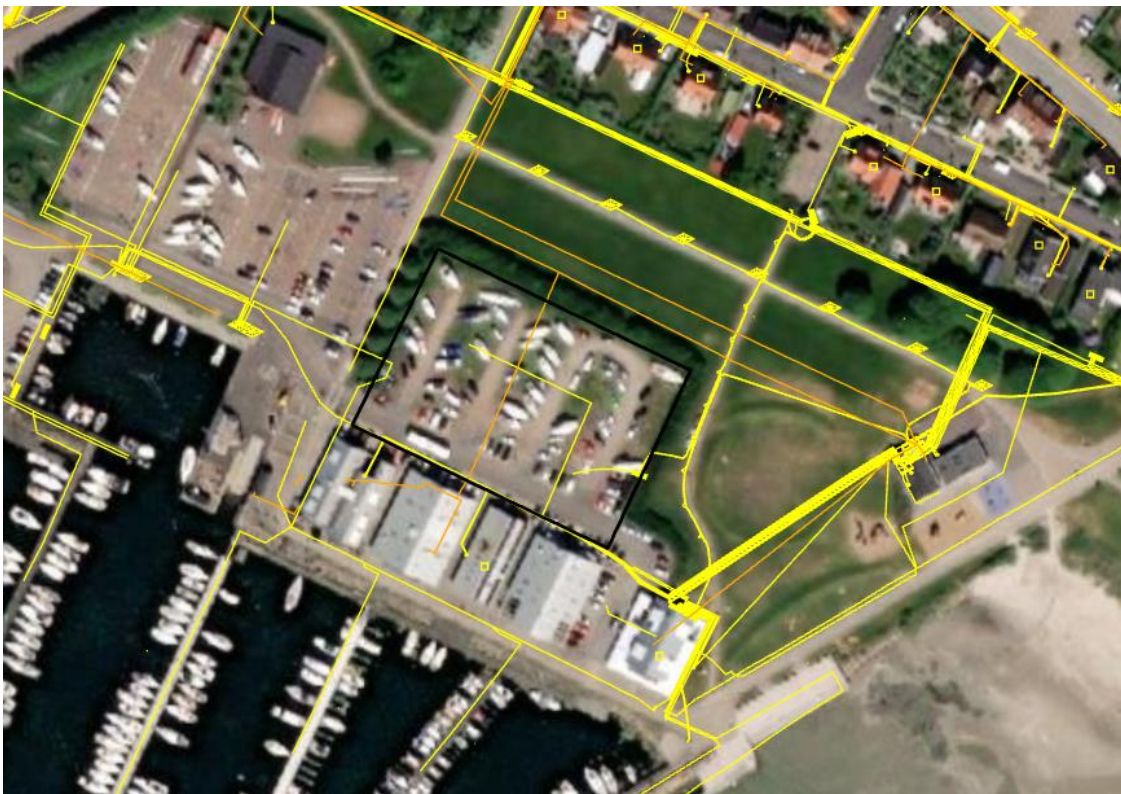
Figur 31. Teleledning tillhörande Skanova (orange) och gatubelysning, el och opto tillhörande Höganäs Energi (gult). Svart streck visar planområdesgränsen.
