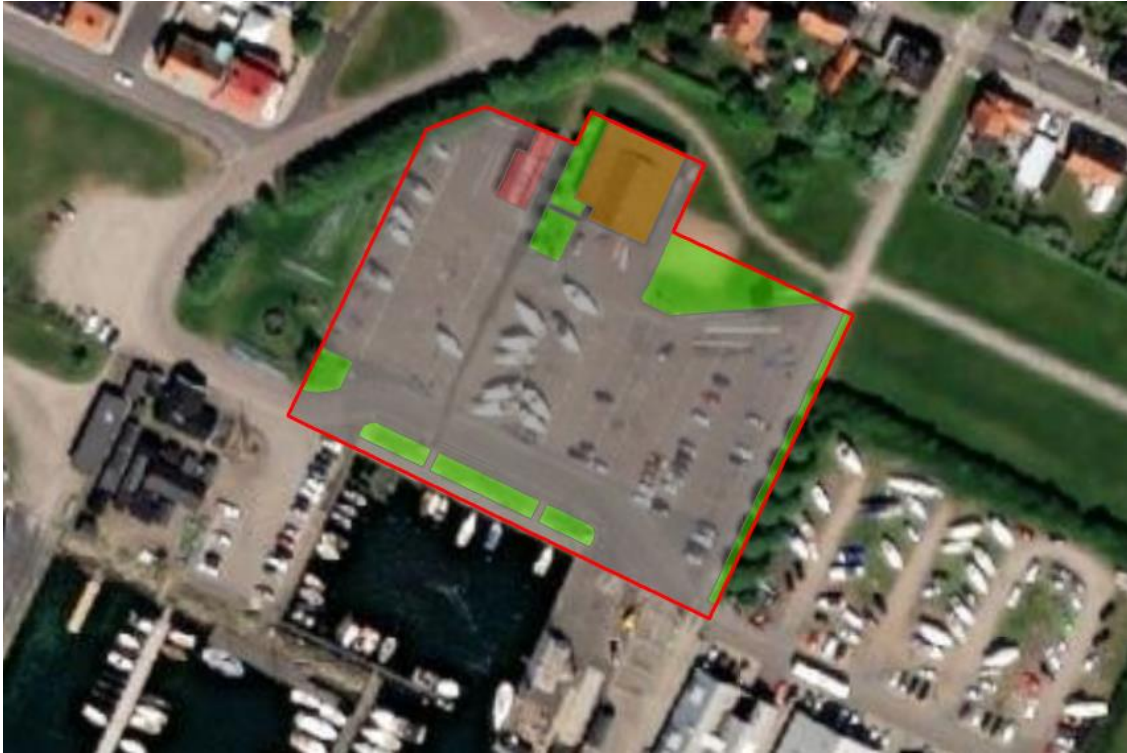
Figur 4. Kartering av markanvändningen i nuläge (ArcGIS Pro, 2022). Grönytor och grusytor visas i grönt, asfalterade ytor i grått, tak i brunt och containrar i rött.
