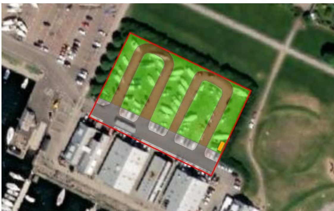
Figur 25. Kartering av markanvändningen i nuläge (ArcGIS Pro, 2022). Naturmark i form av gräs och grus visas i grönt, grusväg i brunt, tak i orange, asfalt i mörkt grått och betongsten i ljust grått.
