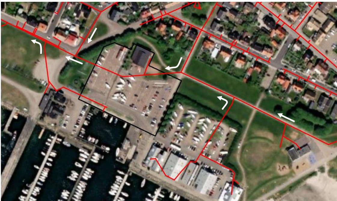
Figur 9. Befintliga spillvattenledningar kring planområdet. Pilar visar flödesriktning.
