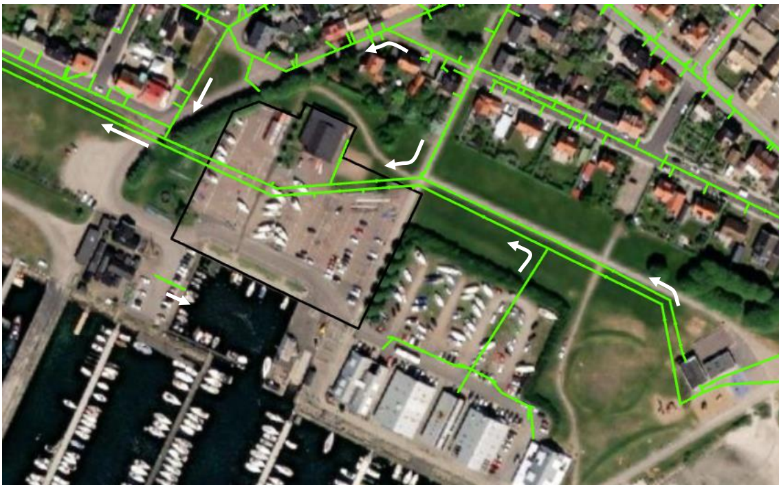
Figur 8. Befintliga dagvattenledningar kring planområdet. Pilar visar flödesriktning.
