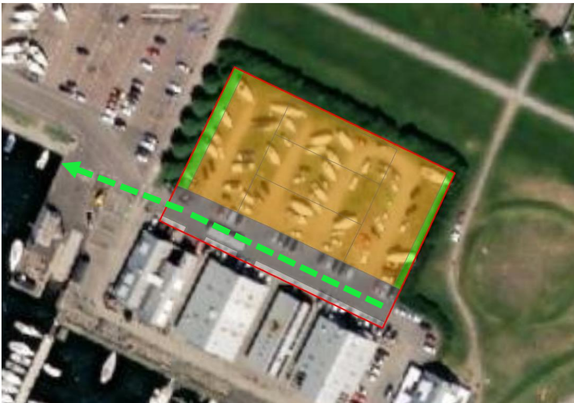
Figur 33. Illustration av föreslagen ny dagvattenledning i lokalgata (grön) och exempel på placering av eventuella regnbäddar/svackdiken (blått).
