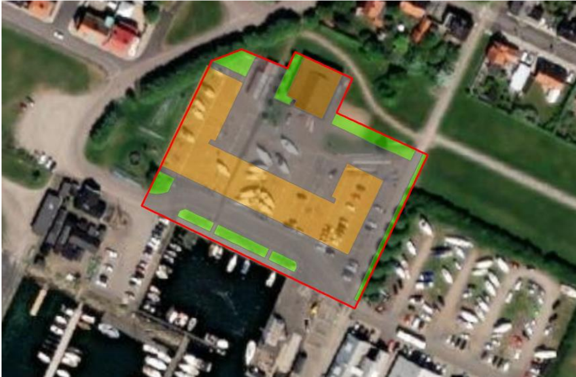
Figur 13. Kartering av markanvändningen efter exploatering enligt plan (ArcGIS Pro, 2022). Grönytor och grusytor visas i grönt, asfalterade ytor i grått och tak i brunt.
