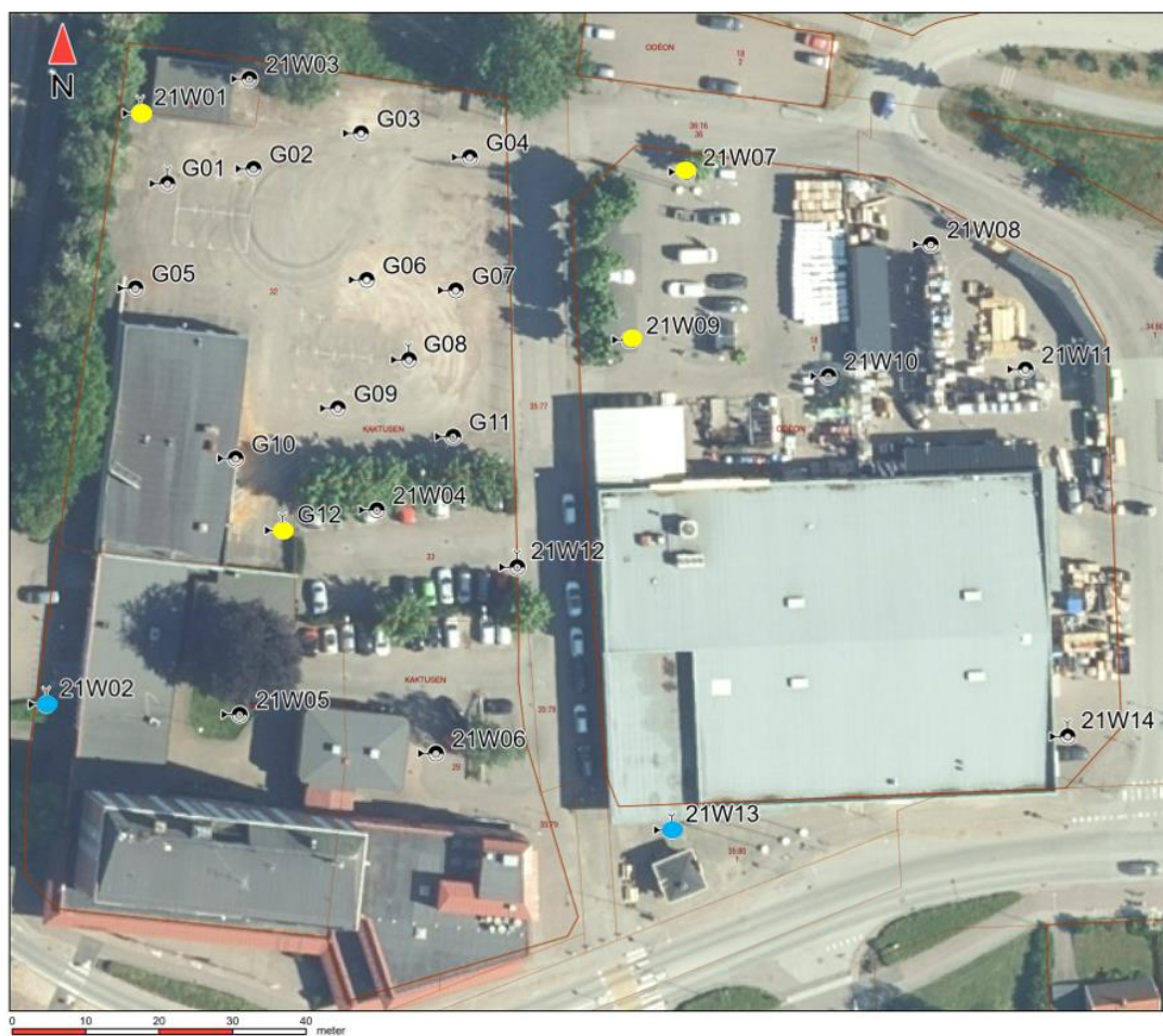
Figur 2. Ritning som visar i vilka halter det har påträffats halter över det generella riktvärdet för KM i jord (gula punkter) samt halter av PFAS (väster) och CAH (söder) blå punkter.
