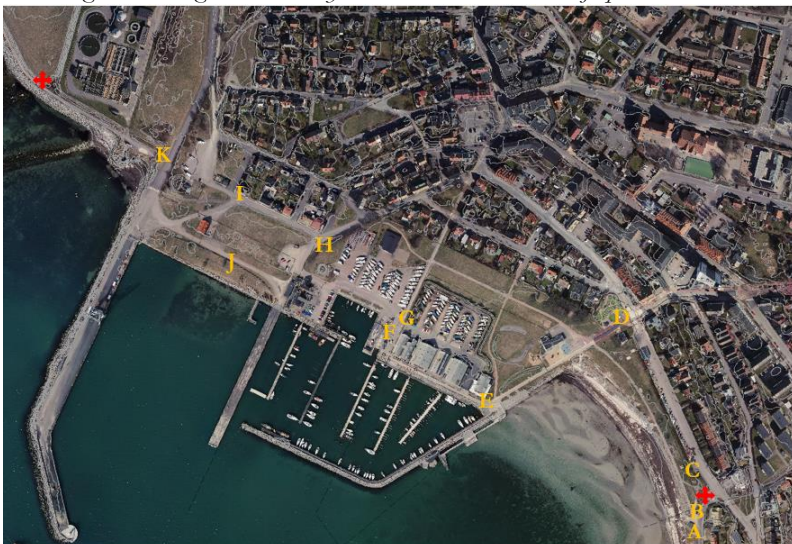
Illustrationskarta över skyddsmurens utsträckning (i ljusgrått) med terrängpunkter i rött. Underliggande blått lager indikerar kommunägda fastigheter i området. Skyddsmuren kommer genomgripande att variera på en höjd mellan 0,5 meter och 1,3 meter över befintlig marknivå vid slutlig höjd år 2150. I södra delen, Läge B – Dansbanan vid Fortet och Kvickbadets södra entré där skyddsmuren ansluter till en höjd på +3,5 m.ö.h. RH 2000. I nordvästliga delen, Läge I – Reningsverket där skyddsmuren ansluter till en höjd på +3,6 m.ö.h. RH 2000.
