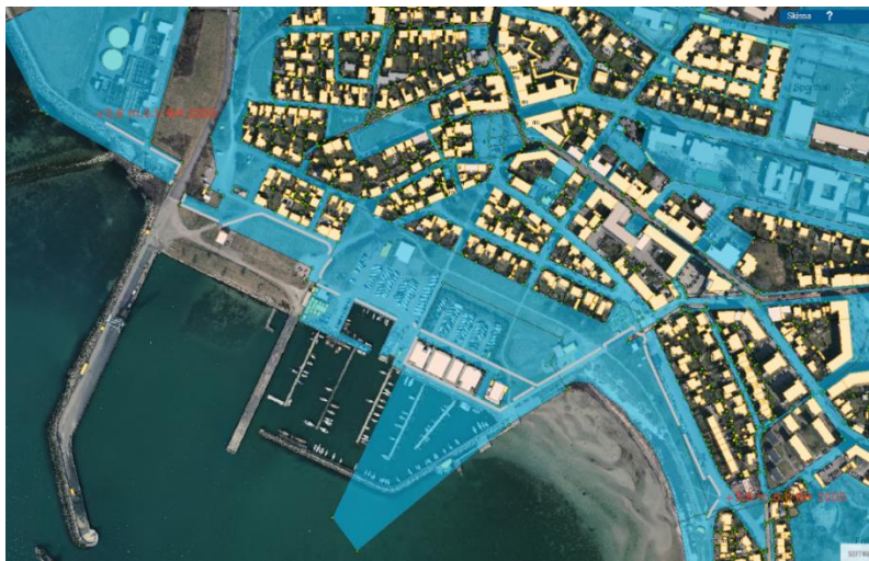
Illustrationskarta över skyddsmurens utsträckning (i ljusgrått) med terrängpunkter i rött. Underliggande blått lager indikerar kommunägda fastigheter i området. Skyddsmuren kommer genomgripande att variera på en höjd mellan 0,5 meter och 1,3 meter över befintlig marknivå vid slutlig höjd år 2150. I södra delen, Läge B – Dansbanan vid Fortet och Kvickbadets södra entré där skyddsmuren ansluter till en höjd på +3,5 m.ö.h. RH 2000. I nordvästliga delen, Läge I – Reningsverket där skyddsmuren ansluter till en höjd på +3,6 m.ö.h. RH 2000.
